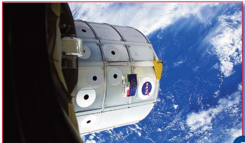
La stazione spaziale Internazionale: l'Asi, in accordo con la Nasa ha realizzato i tre modelli logistici MPLM (Raffaello, Leonardo e Donatello) per il trasporto di materiali sulla ISS (archivio fotografico ASI)
